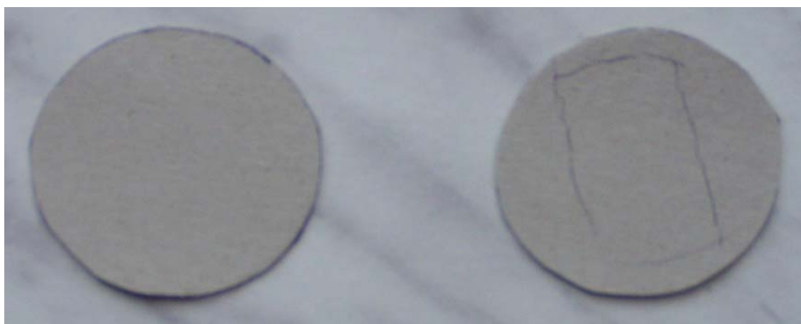
rys. 3: wycięte dekle, na prawym odrysowany kontur żyletki
