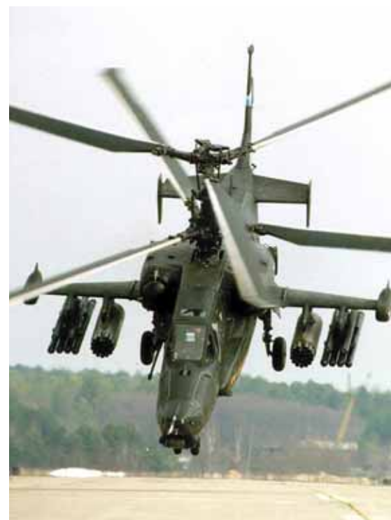
Dwa wirniki nośne śmigłowca Kamow Ka-50 obracają się w przeciwne strony, dając całkowity moment pędu równy zero
